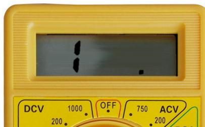
Figura 4: Multímetro fuera de escala.
