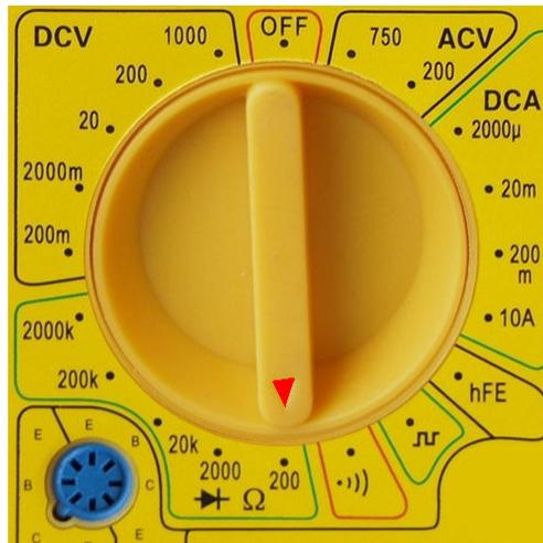
Figura 6: Posición de menor resistencia (200  $\Omega$ ).
