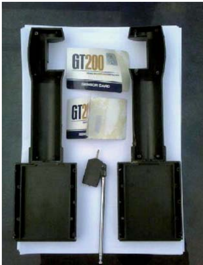
Fotografía del interior de una GT200 [Cortesía de Jomquan Laopet]
